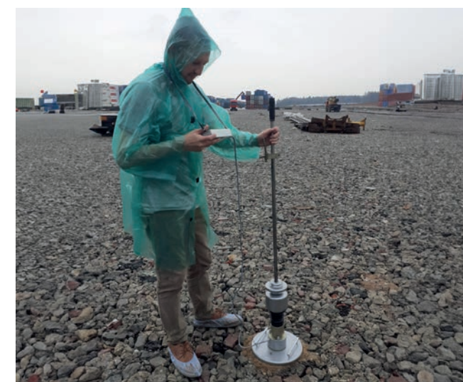
Рис. 4. Контроль прочности основания прибором «ПДУ – МГ 4 «Удар»
