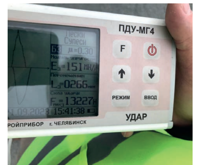
Рис.5. Показания прибора «ПДУ – МГ 4 «Удар»
