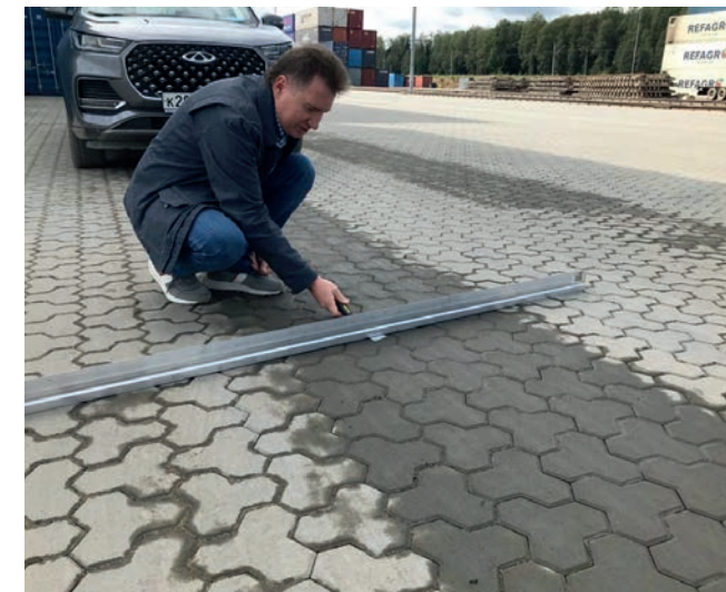
Рис. 2. Измерение ровности покрытия с применением рейки и клиновидного промерника
