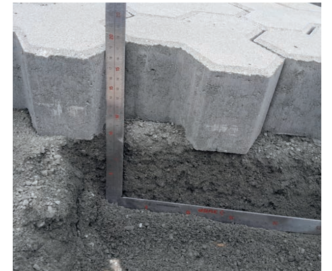
Рис. 1. Измерение толщины подстилающего слоя
