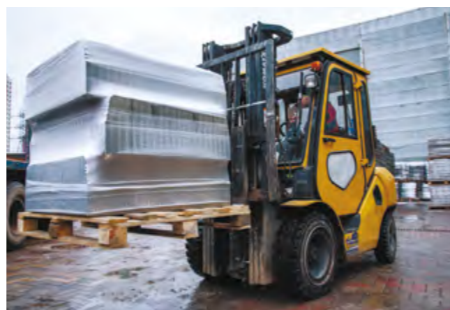
Многослойная упаковка из стрейч-пленки надежно фиксирует изделия при перемещении, погрузке и разгрузке
