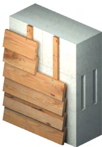
Рис. 7а. Облицовка по направляющим
